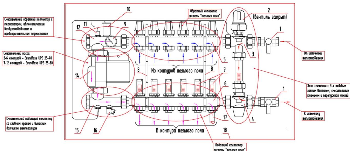
Смесительный клапан [4] предназначен для компенсации линейных расширений и поддержания постоянного расхода теплоносителя в системе «теплый пол» путем ручной регулировки.
