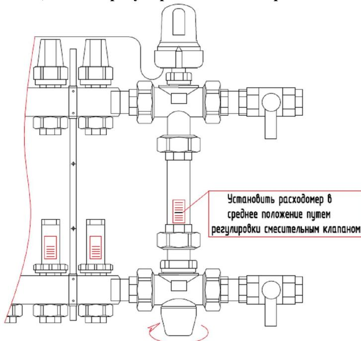
После настройки измерителей напора произвести общую настройку коллекторной системы. При этом смесительный клапан плавно открывается по часовой стрелке, а на обводной линии устанавливается уровень напора в среднее положение.
