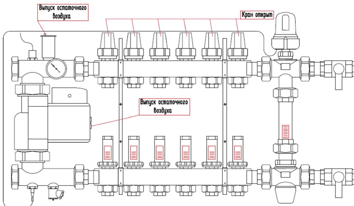
После выпуска воздуха открыть все краны на обратном коллекторе теплого пола и установить термостатическую головку с выносным датчиком. Проверить давление в системе и произвести розжиг отопительного оборудования. При достижении температуры в котле более 40°C, установить на термостатической головке температуру от 35°C до 40°C.
