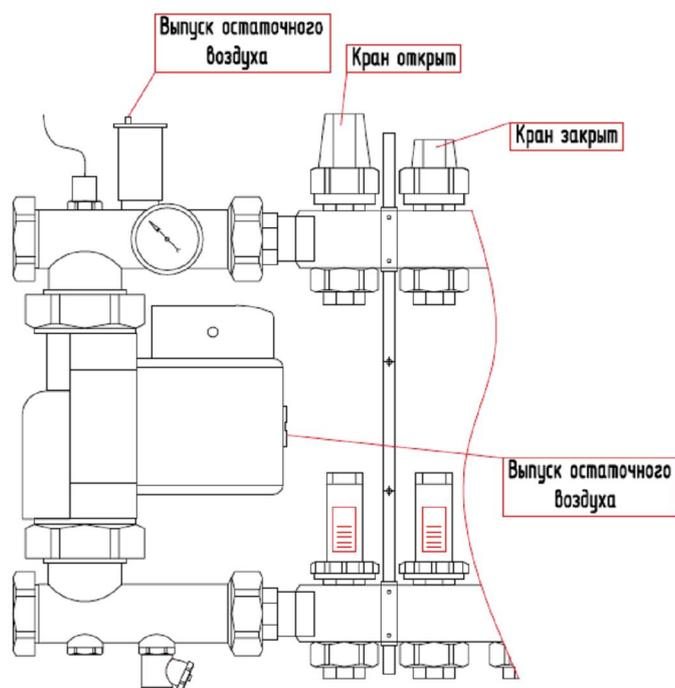
Проверить давление в системе (давление должно составлять от 1 до 2 атм.). На обратном коллекторе теплого пола закрыть все краны, кроме одного.
